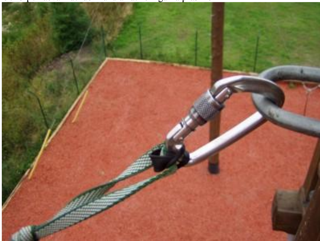
Obr 3 po zacvaknutí do kruhu a zatížení guma praskne
