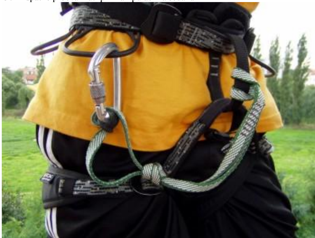
Obr 3 po zacvaknutí do kruhu a zatížení guma praskne
